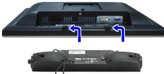
1. Sur l'arrière du moniteur, fixez la Sound Bar en alignant les deux orifices avec les deux languettes sur le bas à l'arrière du moniteur.
